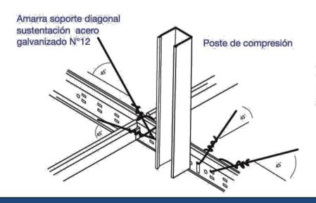
Nota: Poste de compresión y amarras diagonales siempre deben ir instalados en perfil principal.
